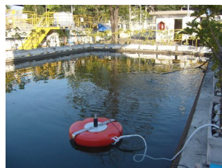
Sonda Flutuante para medir concentração de Oxigênio Dissolvido na superfície de reservatório.
