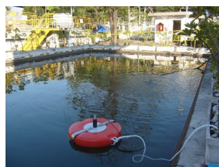
Sonda Flutuante para medir concentração de Oxigênio Dissolvido na superfície de reservatório.
